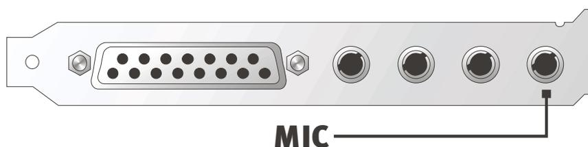
La sensibilità si regola nel ControlPanel della SoundSystem DMX. Inoltre c'è un interruttore per la preamplificazione integrata dell'ingresso per il microfono. Questa testina contrassegnata dalla scritta "BOOST" aumenta la sensibilità dell'ingresso, però comporta un aumento del fruscio .
