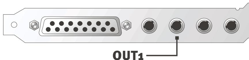
Bei HiFi-Verstärkern gibt es verschiedene Eingänge, die sich für den Anschluss der Karte eignen. So können Sie zum Beispiel nach einem mit AUX, TAPE-(Play), CD oder VIDEO gekennzeichneten Anschluss Ausschau halten. Ein Phono-Eingang sollte jedoch nicht verwendet werden.
