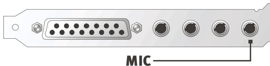
Die Empfindlichkeit regeln Sie im ControlPanel des SoundSystem DMX. Ausserdem steht Ihnen ein Schalter für die eingebaute Vorverstärkung des Mikrofon-Eingangs zur Verfügung. Dieser mit „BOOST“ gekennzeichnete Knopf erhöht die Empfindlichkeit des Eingangs, bringt jedoch auch mehr Rauschen mit sich.
